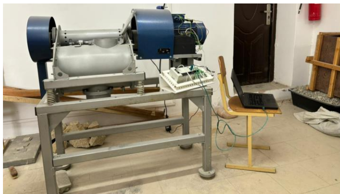
Рисунок 6 – Лабораторная установка ШБМ
